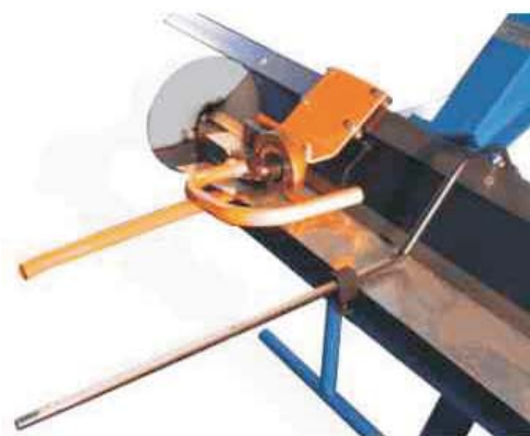
Detal nożyce krążkowych, kątomierza i miernika z podziałką.
